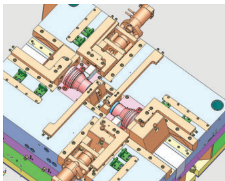
Pohyblivá časť dvojnásobnej formy s vytáčaním závitových jadier pomocou hydromotorčeka
