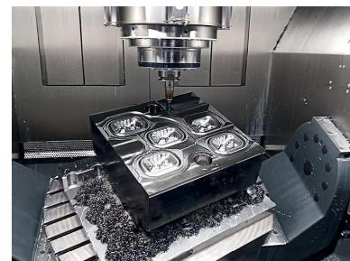
**3** Jako CAD slouží ke konstrukci všech potřebných nástrojů pro zápustkové kování (zápustky, střížné nástroje, ohýbací nástroje, válcovací nástroje, přípravky pro obrábění). V oblasti CAM pak pro obrábění forem, zápustek, kovačích a střížných nástrojů, kusová i malosériová výroba, tříosé i pětiosé frézování, vrtání a závitování. Používáme stroje Tajmac-ZPS MCFV 1260, Kovosvit MAS 750-speed, Kovosvit MAS 1000-speed, Alzmetall GS1000/5 s řídicími systémy Heidenhain iTNC530 a TNC640.
